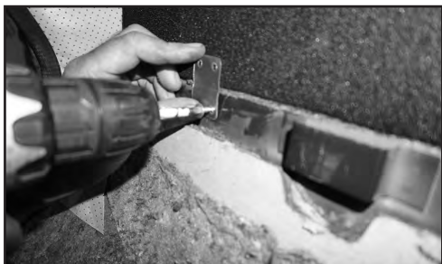
11. С помощью уголков прикручиваем полку к кузову автомобиля белыми саморезами 4,2 x 19 (2шт).
