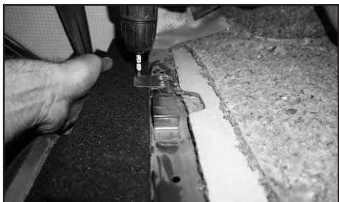
13. Прикручиваем полку к кузову черными саморезами 3,5 x 19 (2 шт) с обеих сторон.
