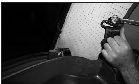
4. Откручиваем болты крепления ремней безопасности с обеих сторон автомобиля.
