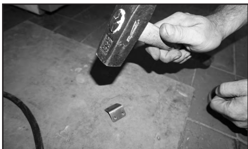
10. Разгибаем два уголка 3,5 x 3,5 молотком.
