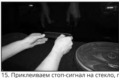
15. Приклеиваем стоп-сигнал на стекло, попросив помощь напарника: один нажимает на педаль тормоза, а другой сзади авто смотрит как расположен фонарь.
