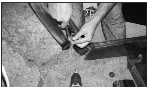
4. Откручиваем болты крепления ремней безопасности с обеих сторон автомобиля.
