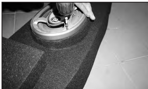
8. Прикручиваем динамик саморезами 3,5 x 32 (8 шт).
