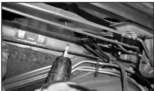
16. Саморезами 3,5 x 90 (2шт) прикручиваем полку из багажника автомобиля (рядом с динамиками), предварительно рассверлив сверлом диаметром 4мм отверстие.
