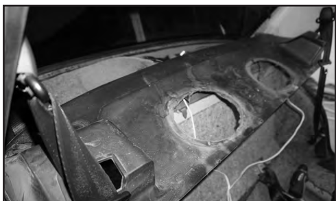
3. Если полка не нужна, то размотав ремни и слегка вытащив полку прорезаем лобзиком и освобождаем ремни.
