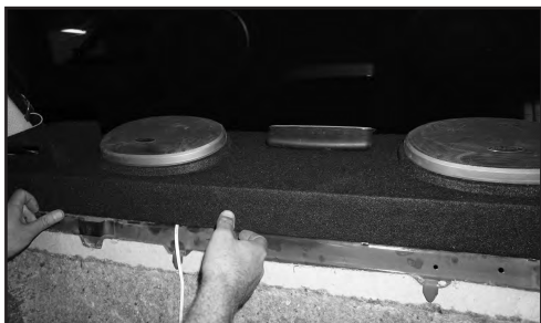
9. Устанавливаем полку на место, проследив что бы провод стоп-сигнала попал в паз и его не пережало.
