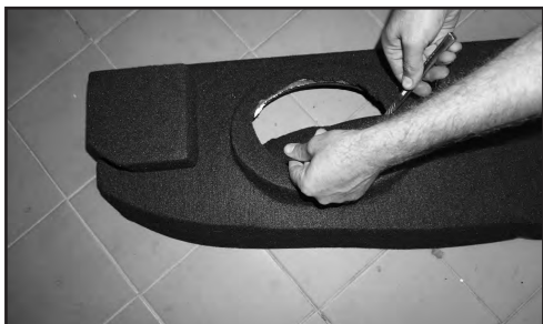
7. Вырезаем ткань на полке в местах крепления динамиков.
