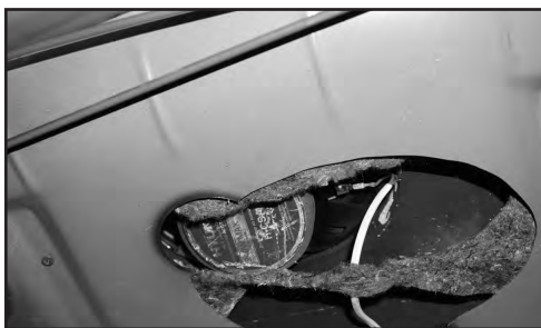
15. Приклеиваем стоп-сигнал на стекло, попросив помощь напарника: один нажимает на педаль тормоза, а другой сзади авто смотрит как расположен фонарь.
