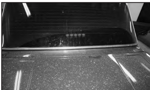
15. Приклеиваем стоп-сигнал на стекло, попросив помощь напарника: один нажимает на педаль тормоза, а другой сзади авто смотрит как расположен фонарь.
