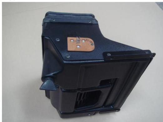
Отопитель представляет собой пластиковый корпус со встроенным электромотором и нагнетателем воздуха.
