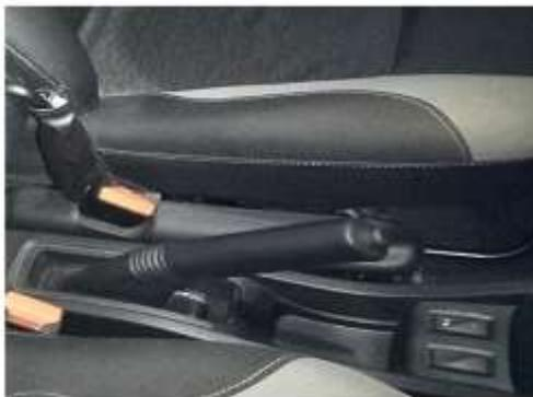
Если, в процессе эксплуатации, подлокотник перестал фиксироваться в поднятом положении, необходимо ключом на 13 мм подтянуть болт М8х45 крепления кронштейна к площадке.
