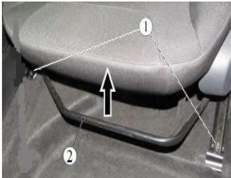
1. Вывернуть два болта (№1) переднего крепления, отодвинуть кресло максимально назад, потянув рычаг (№2) вверх (рис.1)
