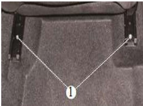
5. Открутить две гайки М8 крепления кронштейна ремня безопасности.
